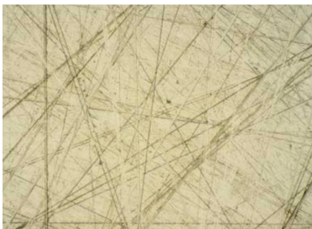
Рис. 5.54 После алмазного полирования царапины от FG не исчезли. Очень глубокая вертикальная царапина, возможно, осталась после PG 200x.
