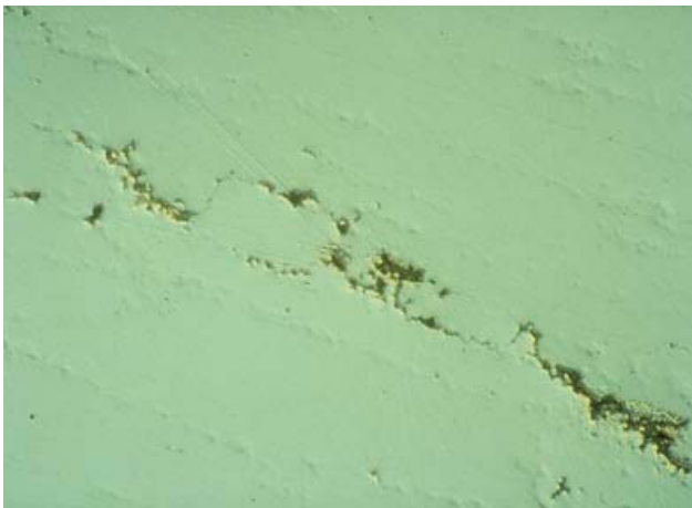
Рис. 5.64 Можно видеть царапины, нанесенные включениями. 500x, DIC
