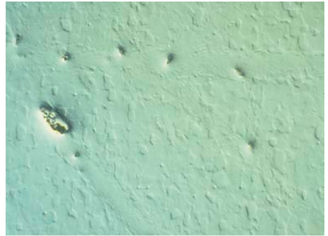
Рис. 5.80 Линии истирания после конечного полирования. Все еще видны большие углубления, также видны деформации, сопровождающие линии истирания. Чистый тантал. 500х, DIC.
