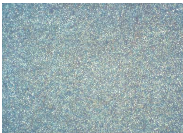
Рис. 5.42 100 Cr 6 Травитель: раствор азотной кислоты в спирте, 500х.
