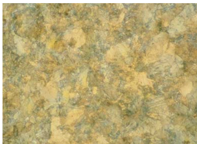
Рис. 5.50 Инструментальная сталь. Травитель: раствор азотной кислоты в спирте, 200х.
