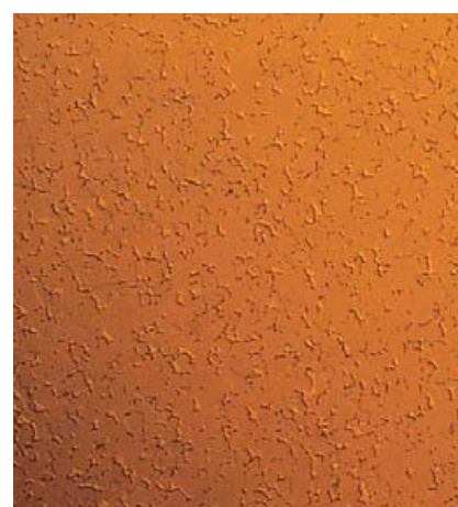
Рис. 5.46 Спеченный карбид. DIC, 1000х.
