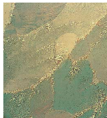
Рис. 5.39 Эвтектический медный сплав с 8,4% P. Травитель: Klemm III, 100x.
