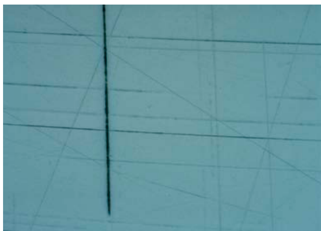
Рис. 5.53 После FG видны царапины от PG 200x.
